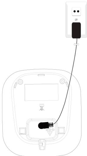
Si conecta el teléfono a una línea con una conexión de banda ancha, necesitará insertar un microfiltro entre el teléfono y la línea telefónica; en caso contrario, puede tener interferencias entre el teléfono y la banda ancha, lo que puede ocasionar problemas.
