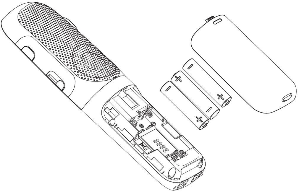
3) Vuelva a colocar la tapa del compartimento de las pilas.
