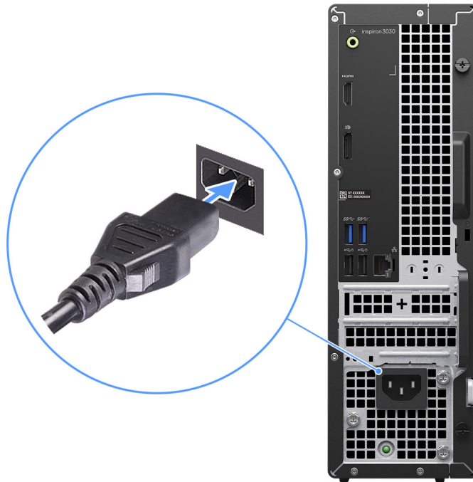
Ilustración 7. Conecte el cable de alimentación
