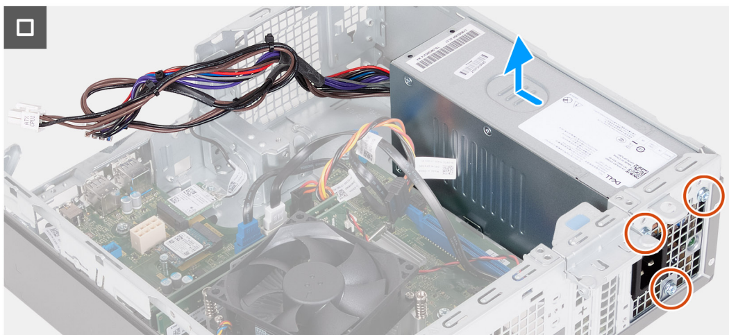
Ilustración 41. Extracción de la fuente de alimentación
