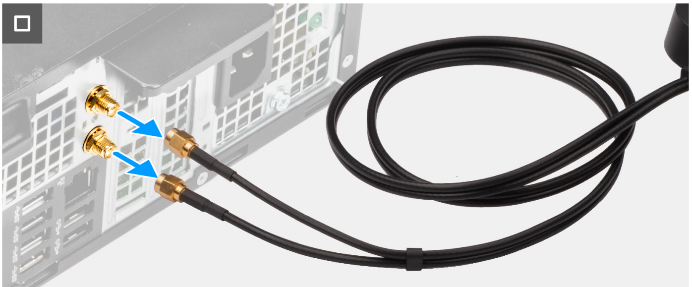
Ilustración 38. Extracción de la antena externa
