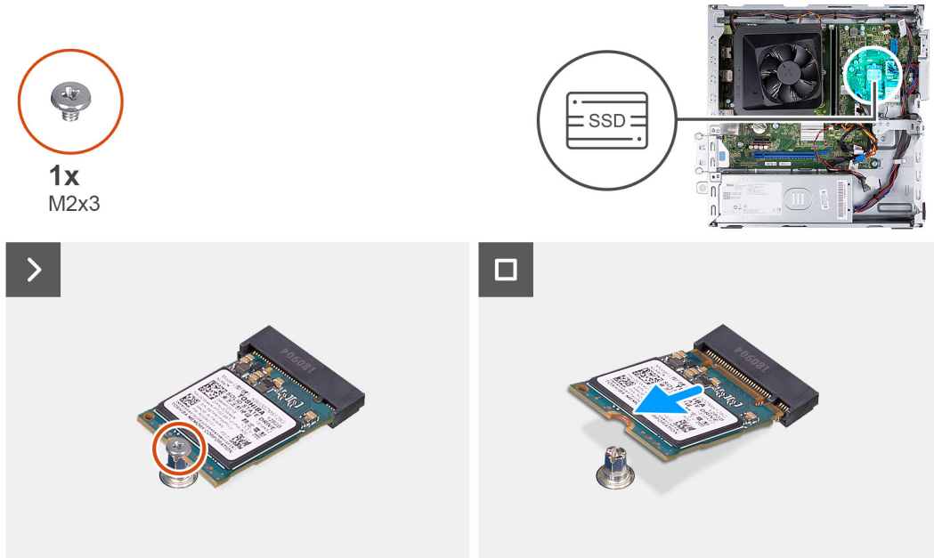
Ilustración 26. Extracción de la unidad de estado sólido M.2 2230
