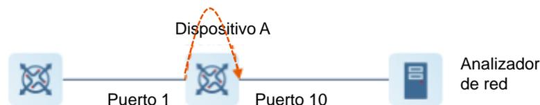
La SPAN logra el análisis del tráfico de datos de nodos o puertos de dispositivos sospechosos en la red sin afectar el reenvío de datos del dispositivo monitoreado. Se utiliza principalmente en situaciones de monitoreo de la red y de solución de problemas.
